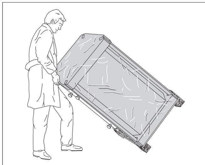
Рис. 4 Установка бака-водонагревателя
